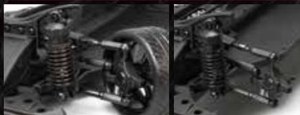
ロアアームは従来どおり軽量の樹脂製を採用しつつ、シャフト部分は新設計の36mm長アルミ製パーツに変更。軽さと高剛性を両立し、ワイドトレッド化によって前輪の転がりとトレース性を高めています。
