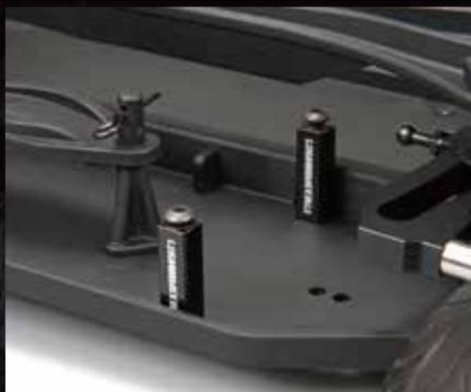
縦置き式のサーボマウントを付属。これによりプロポのEPA調整が左右で揃えやすくなり、ステアリングジャイロの性能も最大限に発揮できる環境が整いました。
