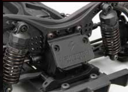
従来型ではシャシー中央付近にESCを搭載していましたが、新たに3Dプリンター製プレート形状のマウントを付属。デフケース上方またはリアオーバーハングに搭載位置を選択でき、重量配分の調整によって切り出し感や高速旋回時の安定性を高めることができます。
